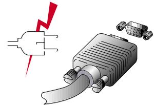
1. Schließen Sie den 15-poligen Anschluß des Signalkabels an den VGA-Anschluß Ihres Computer an und schrauben Sie ihn fest.
