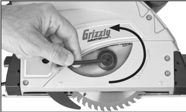
Figure 10. Loosening arbor bolt.
