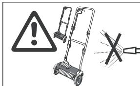
Wegen Gefahr von Schäden am Gerät: Reinigen Sie den Motormäher nicht unter fließendem Wasser, insbesondere nicht unter Hochdruck.
