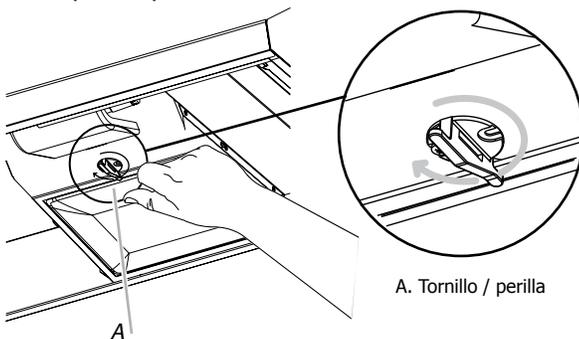
3. Vuelva a colocar el filtro desplazando la orilla trasera de este en el canal de instalación. Empuje el filtro en su lugar y gire la perilla para asegurarlo a la campana.
