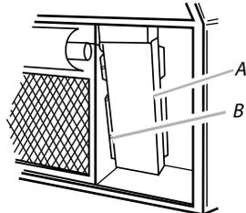
3. Quite el disco removible de suministro eléctrico de la parte superior o posterior de la capota de ventilación (dependiendo de la ubicación de la entrada del cable de suministro eléctrico de su casa) e instale un protector de cables de 1/2" que esté en la lista de UL o aprobado por CSA.
