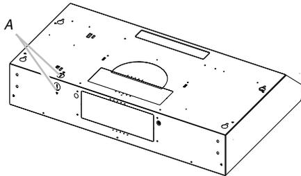
4. Con la ayuda de 2 o más personas, levante la campana y colóquela en su posición final. Haga pasar suficiente cable eléctrico a través del protector de cables de 1/2" que esté en la lista de UL o aprobado por CSA para hacer las conexiones en la caja de terminales. Apriete los tornillos del protector de cables.
