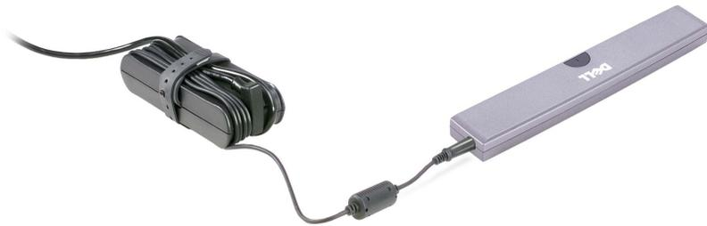
**⚠ 警告：**複数のコンセントがある電源タップを使用する場合、ACアダプタの電源ケーブルを電源タップへ接続する際は、特に注意してください。電源タップによっては、プラグが正しく差し込まれていなくても、差し込めることがあります。電源プラグを正しく差し込まないと、コンピュータが完全に損傷したり、感電したり発火する恐れがあります。電源プラグのアースピンが、電源タップの対となるアース端子に挿入されていることを確認してください。
