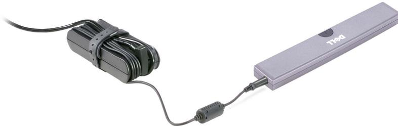
**⚠ 警告：** 如果您使用的配电盘配有多个插座，则在将交流适配器的电源电缆插入配电盘时应小心谨慎。某些配电盘可能会允许您错误地插入电源插头。错误地插入电源插头可能会对计算机造成永久性的损坏，同时还可能会导致电击和（或）起火。请确保将电源插头的接地插脚正确插入配电盘的相应接地触点。
