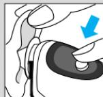
4. Haal de sonde uit de gehoorgang. Het LCD-display laat de gemeten temperatuur zien en het symbool voor het lenskapje.
