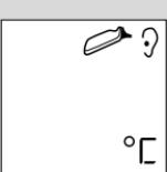
6. Si transcurridos 30 segundos desde la última medición no se ha presionado ningún botón o no se ha colocado ningún protector de sonda, el termómetro se desconectará automáticamente.
