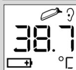
Las pilas se han agotado. El termómetro no puede tomar la temperatura correctamente.
