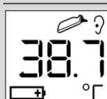
De batterijen zijn bijna leeg, maar de thermometer kan nog steeds correct de temperatuur opnemen.
