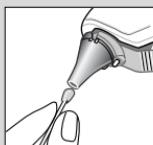
Pour nettoyer la lentille, essuyez doucement sa surface avec un tampon d'ouate légèrement humidifié d'alcool et essuyez immédiatement avec un tampon d'ouate propre et sec.
