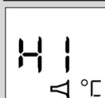
La temperatura tomada no está entre el rango de temperatura mostrado (20°C-42,2°C).
