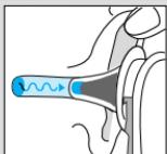
Braun ThermoScan misst die Infrarot-Wärme, die vom Trommelfell und dem umliegenden Gewebe abgegeben wird. Um ein genaues Messergebnis zu erzielen, führt das Thermometer in einer Sekunde 8 Messungen durch und zeigt die höchste Temperatur an.
