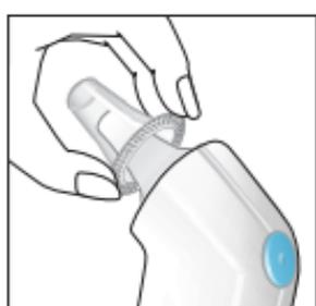
5. Przed kolejnym pomiarem zdejmij zużyty kapturek ochronny i załóż nowy, czysty kapturek ochronny. Skasuj wynik wcześniejszego pomiaru naciskając raz przycisk «start». Wsuń czujnik w przewód słuchowy, a następnie naciśnij przycisk «start».
