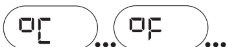
Zwolnij przycisk «start» gdy wyświetlony zostanie symbol «°F». Nowe ustawienie zostanie potwierdzone krótkim sygnałem dźwiękowym a termometr automatycznie się wyłączy.
