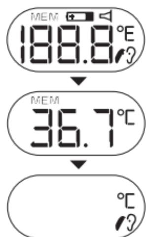
Podczas automatycznego testu urządzenia, na wyświetlaczu (6) zostaną wyświetlone wszystkie segmenty. Następnie wyświetlony zostanie wynik ostatniego pomiaru razem z «MEM».
