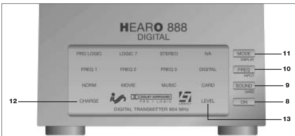
Fig. 2: Bedienelemente an der Frontplatte des Senders
