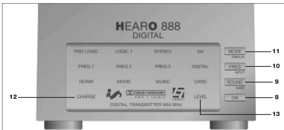
Fig. 2: Elements de comande sur la façade.
