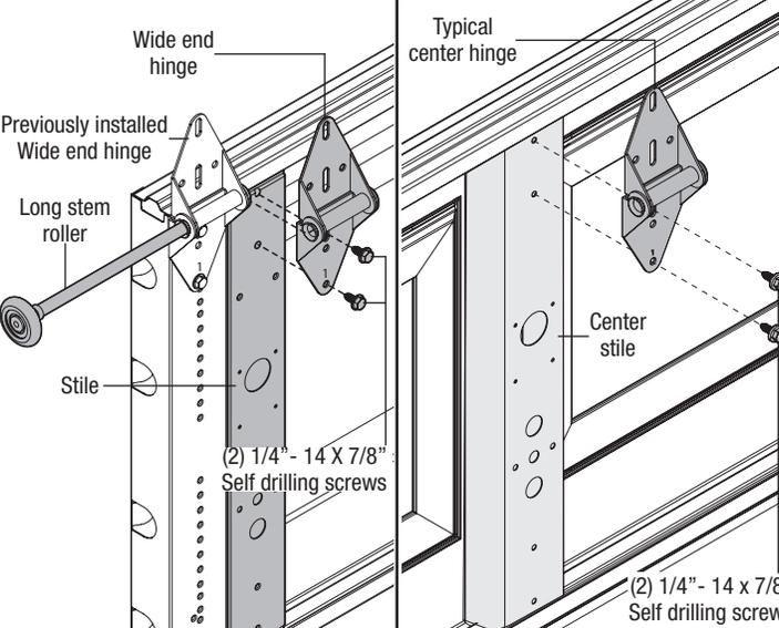
(C) WIDE END HINGE INSTALLATION (D) TYPICAL CENTER HINGE INSTALLATION
