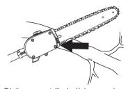
Réaliser une entaille de décharge sur la partie inférieure de la branche avant de couper cette dernière. Cette entaille empêche l'écaillage de l'écorce de l'arbre pouvant provoquer des blessures durables et difficiles à guérir sur l'arbre. Pour éviter tout blocage, la profondeur de cette entaille ne doit pas dépasser 1/3 de l'épaisseur de la branche. Toujours retirer l'équipement de coupe de la branche avec la chaîne qui tourne afin d'éviter le blocage de l'équipement de coupe.
