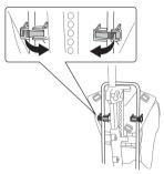
· Desserrez la platine arrière du cadre d'un côté.
