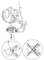
Serrez l'écrou fermement (env. 15 Nm) à l'aide de la clé mixte.
