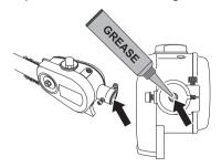
3 Ajoutez la graisse en insérant le tube de graisse le plus loin possible dans le trou, et remplissez jusqu'à ce que de la graisse commence à s'écouler du trou.
