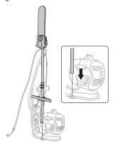
Enroulez le fil autour du réducteur de charge et du tube de transmission, et attachez-le comme indiqué sur la figure.
