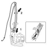
Démontez le tube de transmission. Desserrer le raccord en tournant la manette (au moins 3 fois).
