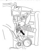
6 Pour procéder au réglage, tournez la vis de réglage (B) dans le sens des aiguilles d'une montre et effectuez à nouveau l'étape 5 jusqu'à ce que l'axe d'accélération du carburateur atteigne le réglage d'accélération maximum.
